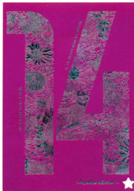
MARQUAGE À CHAUD
